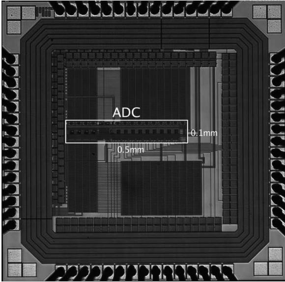
Fig. 12. Die photo of 0.05 mm<sup>2</sup> ADC in 0.18 μm CMOS.
